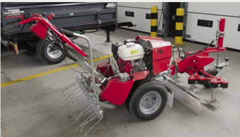
Mechanisch schoffelen: de schoffelmachine.
